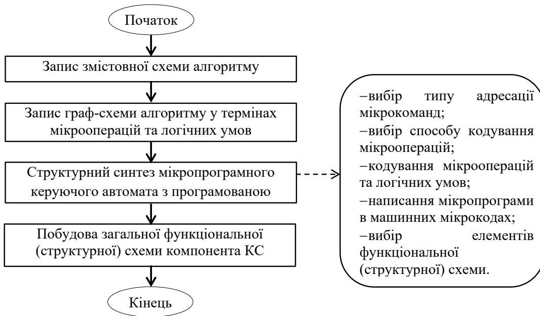
Рис. 3. Алгоритм синтезу керуючих автоматів з програмованою логікою
